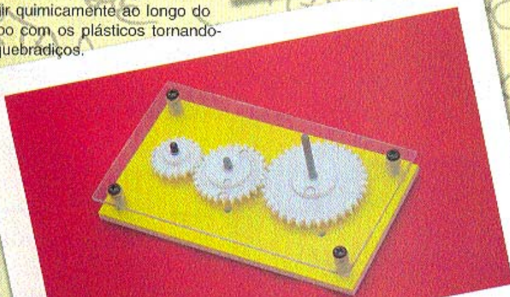
Figura 6 - Caixa de redução finalizada.
